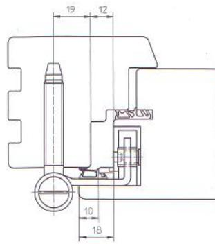
**Наплав 18 мм с уплотнителем на фальце
