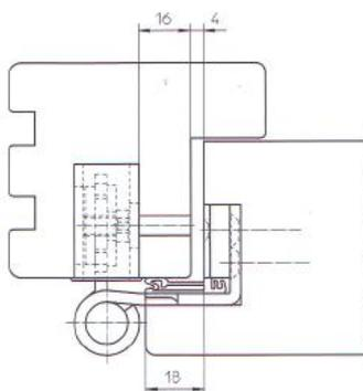
Наплав 18 мм с уплотнителем на фальце
