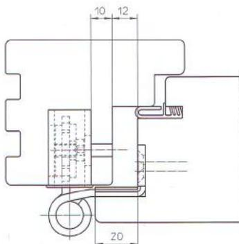
Наплав 20 мм с уплотнителем на фальце
