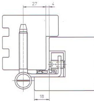
**Наплав 18 мм с уплотнителем на фальце
