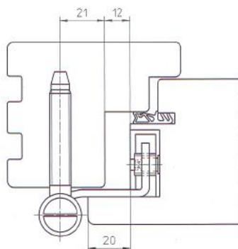
**Наплав 20 мм с уплотнителем на фальце
