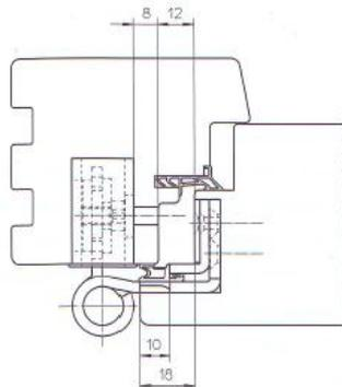
Наплав 18 мм с уплотнителем на фальце
