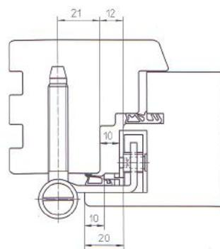
**Наплав 20 мм с уплотнителем на фальце
