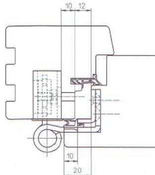
Наплав 20 мм с уплотнителем на фальце
